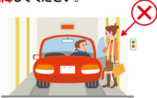
駐車装置を操作する際には、機械式立体駐車場の中に**人がいないことを十分確認**した上で操作してください。
